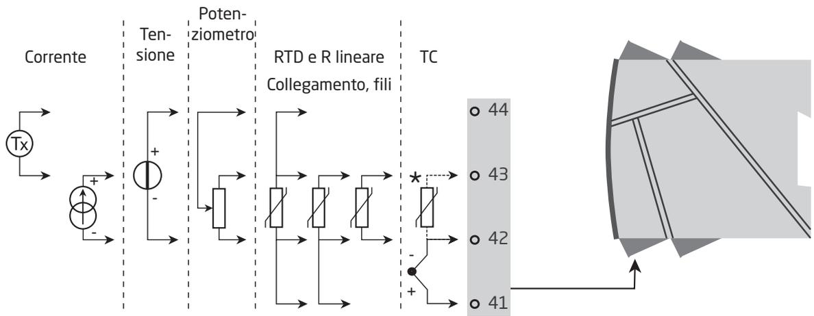
Ordinare separatamente il connettore CJC 5910. Vedere lo schema di collegamento a pag. 17.
